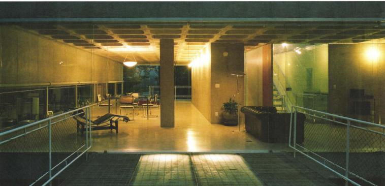
La casa ocupa una parcela de 20 m de frente por 40 m de fondo, con un desnivel de 8 m. La estructura es de hormigón armado de formas plásticas y forjado reticular. La planta se resuelve con un cuadrado de 16.20 x 16.20 m con un vacío central que contiene las escaleras e ilumina los ambientes de servicio. La casa se eleva sobre el suelo de forma que el espacio que deja bajo ella
