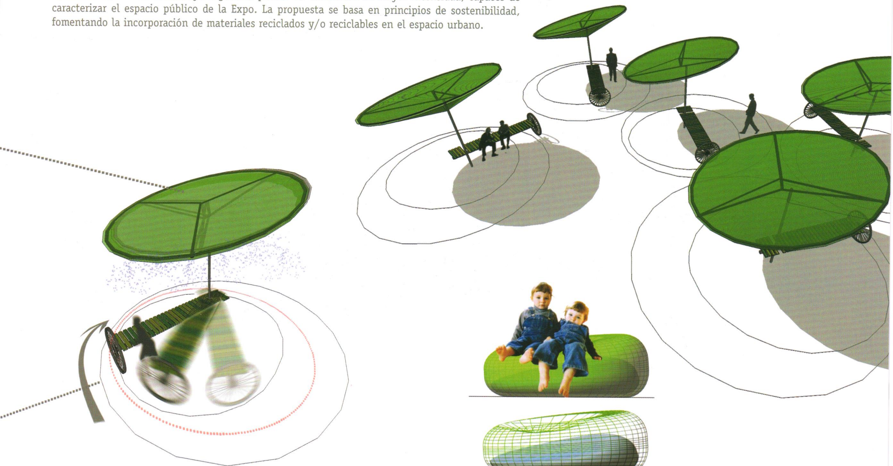
Banco-girasol y Sombra Fotovoltaica. Piezas textiles y de plástico reciclado.
